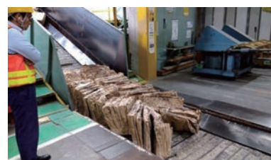
使用済みクラフト紙袋がベルトコンベヤで運ばれ、パルパーに投入され溶解（離解）されます。
