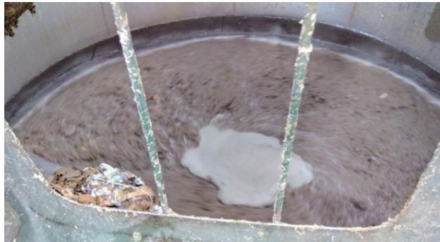
使用済みクラフト紙袋がベルトコンベヤで運ばれ、パルパーに投入され溶解（離解）されます。
